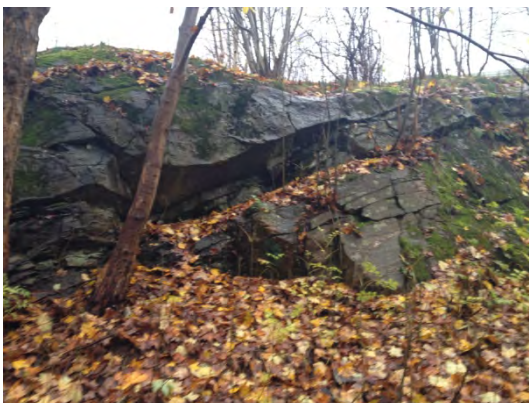
Foto 11 och 12. Lutande spricksystem 50° åt sydväst in mot bergmassan, berget är uppsprucket som skivor
