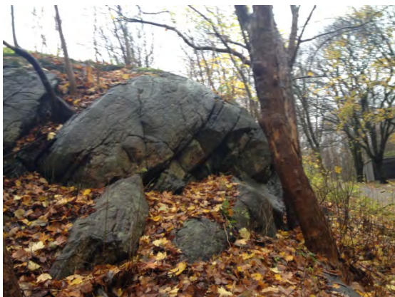
Foto 11 och 12. Lutande spricksystem 50° åt sydväst in mot bergmassan, berget är uppsprucket som skivor
